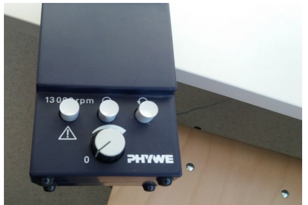
Zdj. 4. Układ do regulacji prędkości obrotowej
