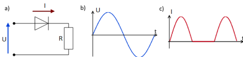
RYСУNEK 8 UKŁAD PROSTOWANIA PÓŁFALOWEGO: A) SCHEMAT; B) PRZEBIEG NAPIĘCIA C) PRZEBIEG PRĄDU
